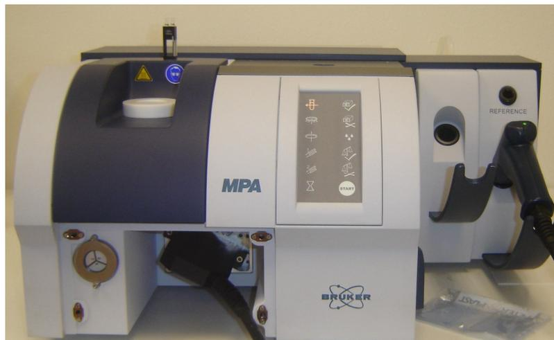
*Figura 13: Spettrofotometro FT-NIR con sistema di lettura in trasmissione Bruker Optics, mod. MPA.*
