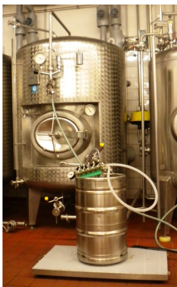
Figura 23: trasferimento di 25 kg di vino in un keg tramite collegamento al serbatoio in acciaio inox retrostante. Il peso del vino prelevato viene monitorato con la bilancia posta sotto il keg.
