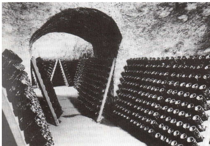
Figura 2: Pupitres situate in uno spumantificio con installate le bottiglie di spumante durante la fase di remuage . Fonte: Bach, H.P., Troost, G. & Rhein, O.H., 2010, p 320.
