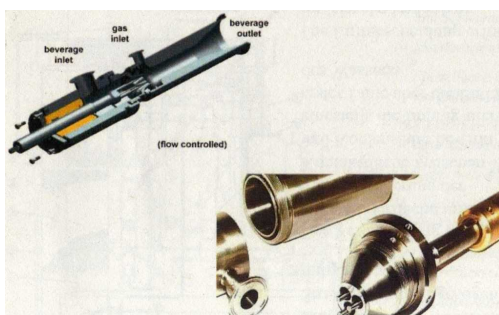
Figura 10: Esempi di ugelli impiegati nella carbonicizzazione delle bevande. Fonte: Appunti di lezione, professor ing. Mark Strobl, Geisenheim.
