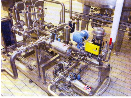
Figura 13: Esempio di impianto di cavitazione. Fonte: Appunti di lezione, professor ing. Mark Strobl, Geisenheim.
