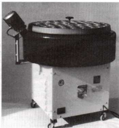
Abb. 133. a = Gefrier-Tauchbottich mit Drehlochscheibe zur Aufnahme der Flaschen. Der Behälter zur Aufnahme der Kältssole ist isoliert, um die Kälteabstrahlung zu vermindern. Die Sole wird durch die Verdampfung eines Kältemittels gekühlt, das durch den Kompressor wieder verdichtet wird. b = Sektflasche während des Einfrierens des Hefedepots in einer Flaschenhals-Einfrieranlage. Eintauchtiefe in die Sole bis 6 cm. c = Gesamtansicht eines Gefrier-Tauchbottichs.
