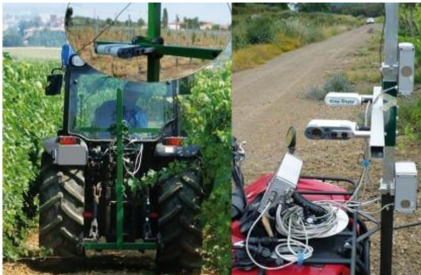
Sistemi di rilevamento ottico direttamente montati su trattore agricola
