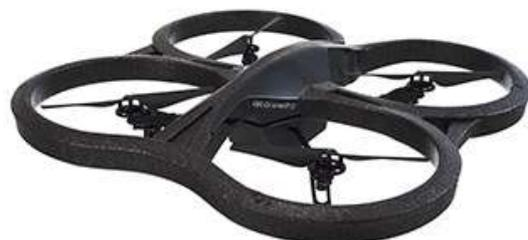
perspiegare in termini pratici le capacità di trasporto del drone. Il suo peso limite per decollare è di 150g, a cui vanno aggiunti 78g della carena (copertura in carbonio che protegge le parti interne del drone), ed i 33g del GPS per un totale di 260g. Pesando 366g, il drone è in grado di sollevare circa il 70% in più del proprio peso.
