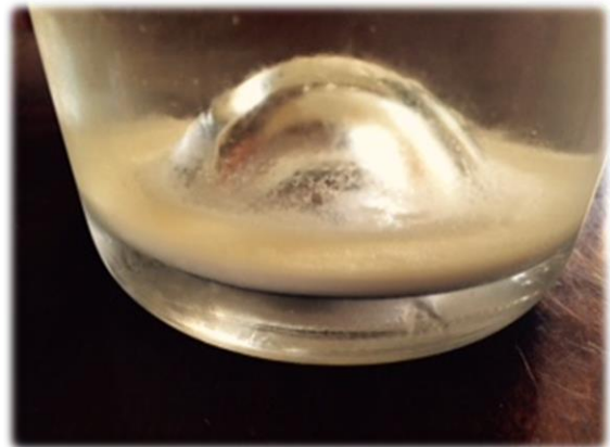
Precipitazione di sali dell'acido tartarico
